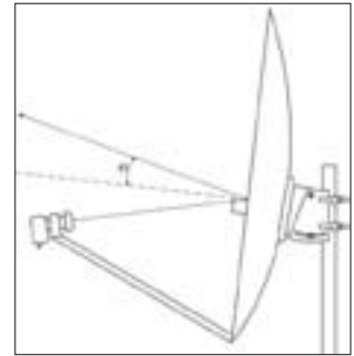
Благодаря форме офсетной антенны, ей не приходится «смотреть» вверх подобно прямофокусной. Причем, сама антенна обладает так называемым углом офсетности
