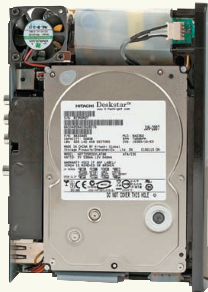
Внешний жесткий диск с Ethernet-интерфейсом и со снятой крышкой
